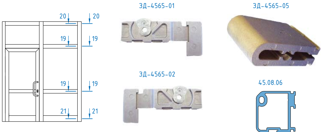
Вариант крепления ригелей с помощью винтов и фиксаторов
